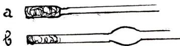
Fig. 3. — Detalle de la terminación de la extremidad de la pipeta. a , estrangulación para retener el algodón; b , pipeta con un pequeño ensanchamiento de seguridad
