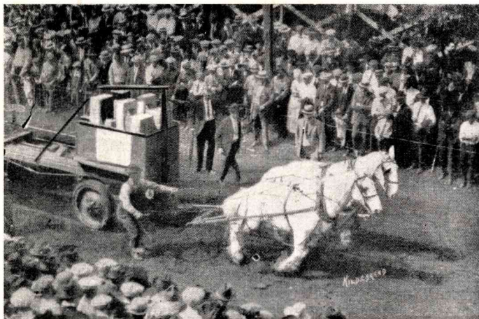
Fig. 7. — El carro dinamométrico utilizado en los ensayos de los animales presentados a concurso realizado en la Escuela de Agricultura de Iowa (E. U.) el año 1923
