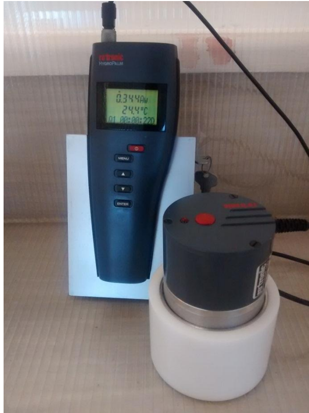
Figura 8: Equipo Rotronic Hygropalm para medición de a_w .
