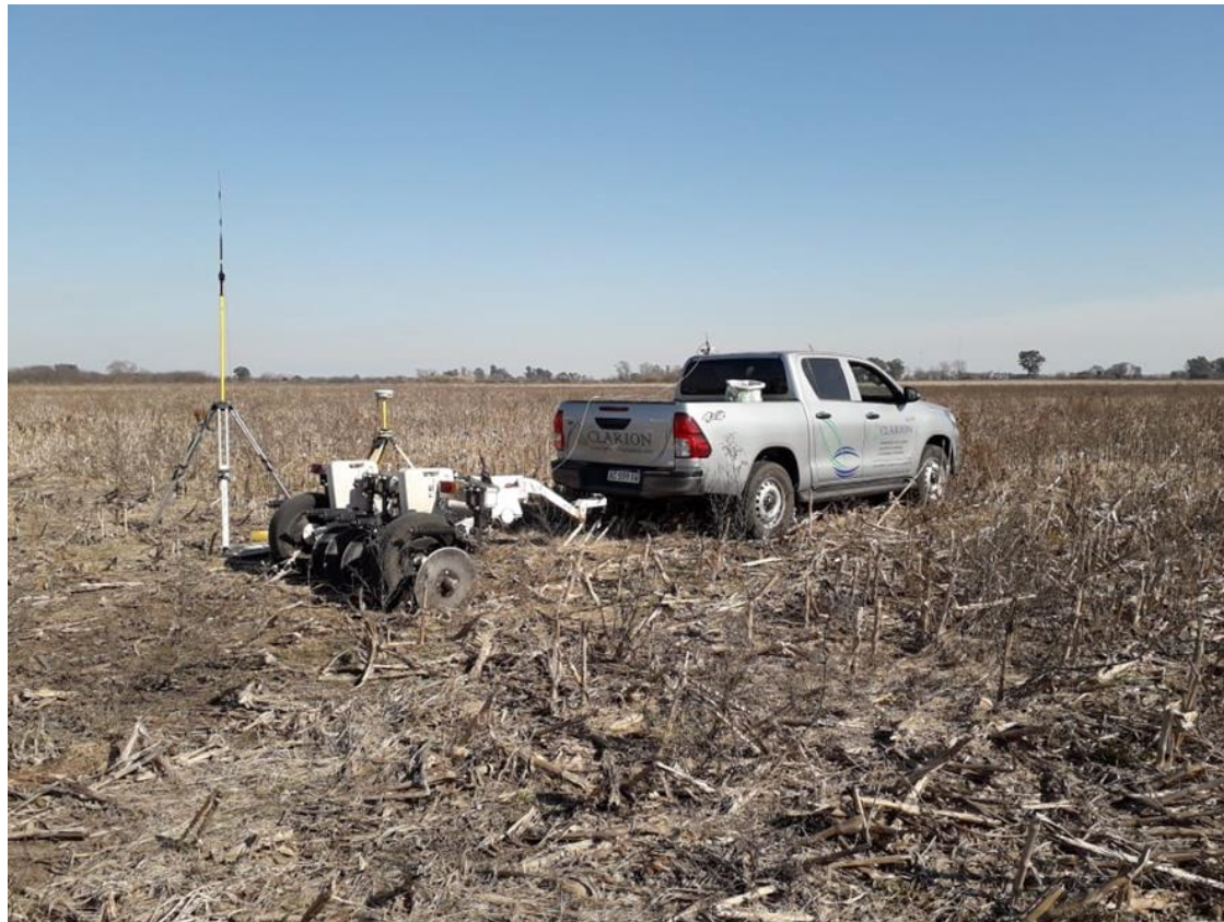
Figura 4. Equipos de medición Trimble 5700 RTK-GPS y VERIS 3100 utilizados para relevar altimetría y conductividad eléctrica aparente, respectivamente.
