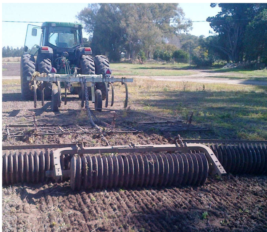
Figura 2.4: Grupo en serie de herramientas (cincel de púas, rastra de dientes y rolo desterronador) utilizados para incorporar las enmiendas en una sola pasada mediante labranza mínima
