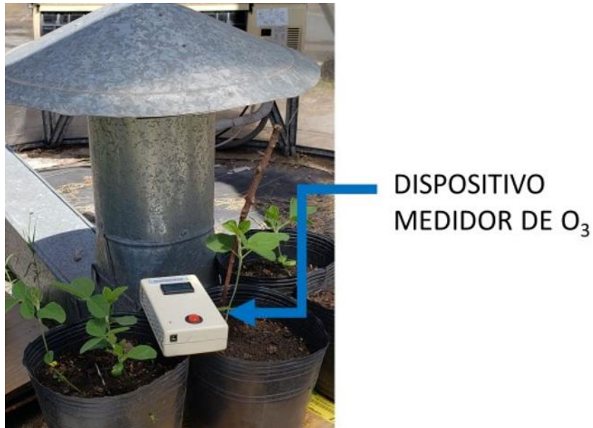
Figura 2.3 Dispositivo de medición manual de concentración de O 3 en las cámaras.
