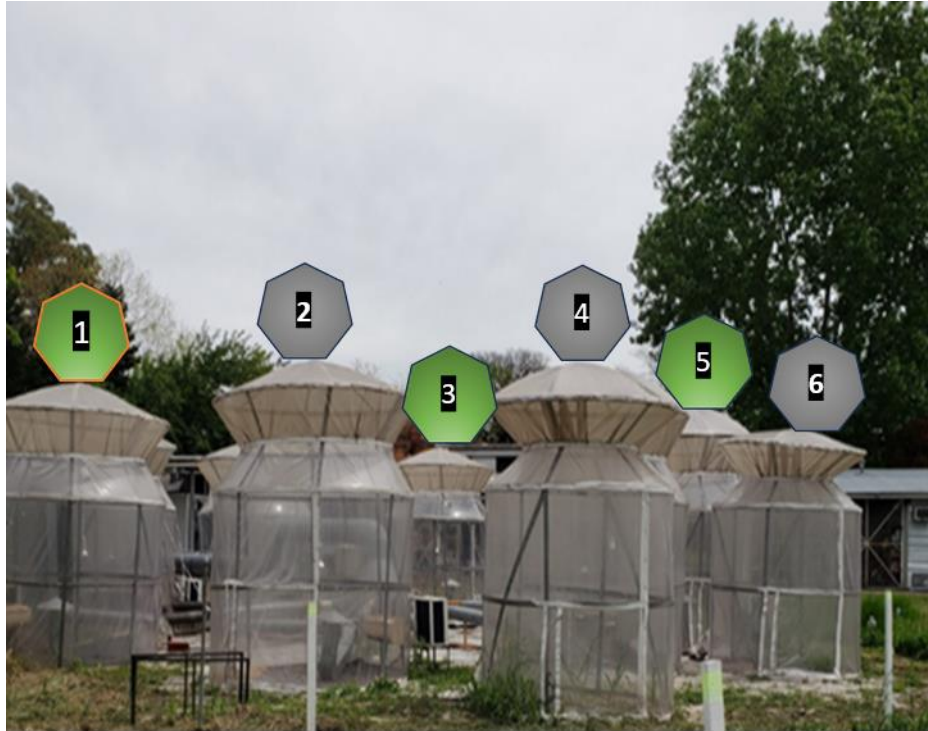
Figura 2.1: Cámaras utilizadas en el ensayo. Los tratamientos fueron: tres cámaras con fumigación crónica de ozono (40-50 ppb O_3 ) y tres para el ambiente control (Ambiental).
