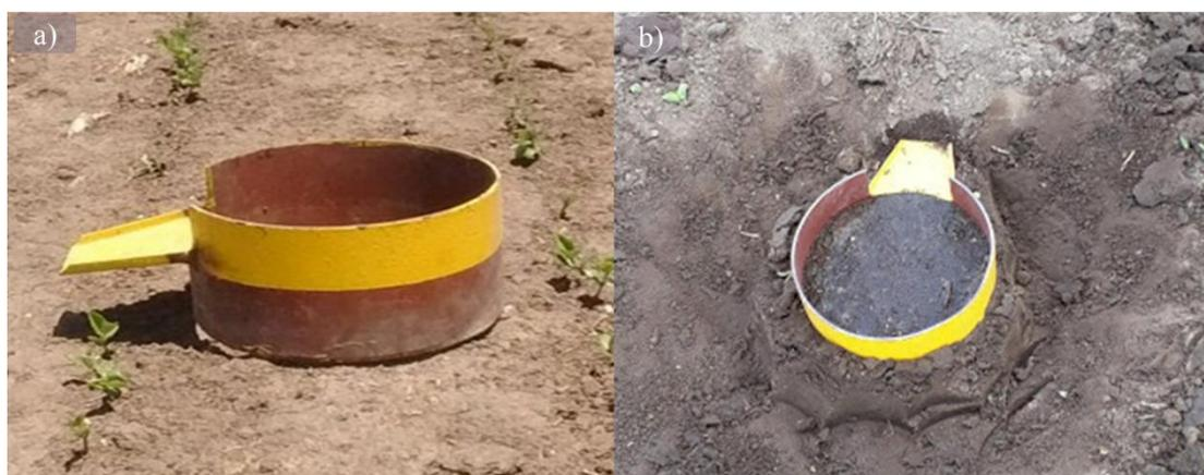
**Figura 3.1.** a) Parcela metálica dispuesta en el terreno previo a la extracción del suelo sin disturbar, b) Extracción de parcela, luego de la aplicación de agua superficial.
