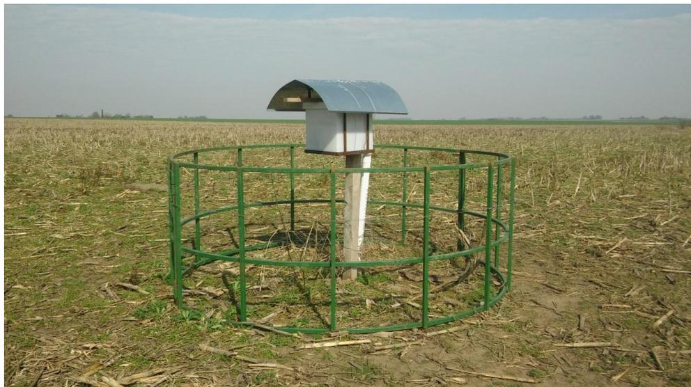
**Figura 2.2.** Limnógrafo instalado en cercanías de la vaguada.
