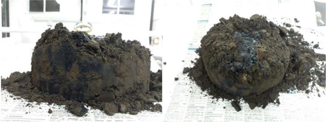
**Figura 3.6.** Monolitos de suelo luego de ser separados de las parcelas metálicas y teñidos con el colorante azul brillante para la evaluación del movimiento del agua dentro del monolito mediante observación directa.
