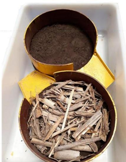
**Figura 3.2.** Parcelas con cobertura (CC) y sin cobertura (SC) de rastrojo de maíz (equivalente a 7110 kg MS ha<sup>-1</sup>) dispuestas en bandejas de plástico en el laboratorio.
