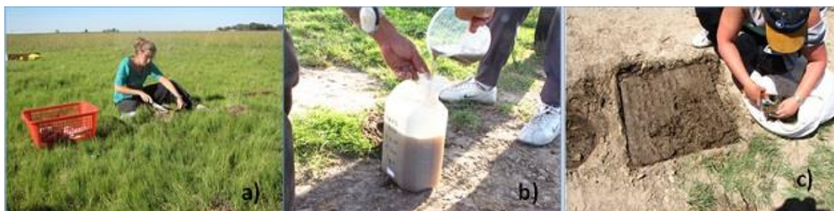
Figura 2.10: Muestro de suelo (a), recolección de escurrimientos (b) y extracción de la biomasa aérea sobre el suelo (c).
