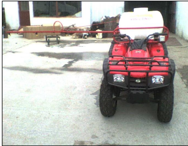
Figura 7. Cuatriciclo pulverizador de 4 picos. El equipo se desplaza por pasillos laterales a las parcelas para la aplicación del producto.
