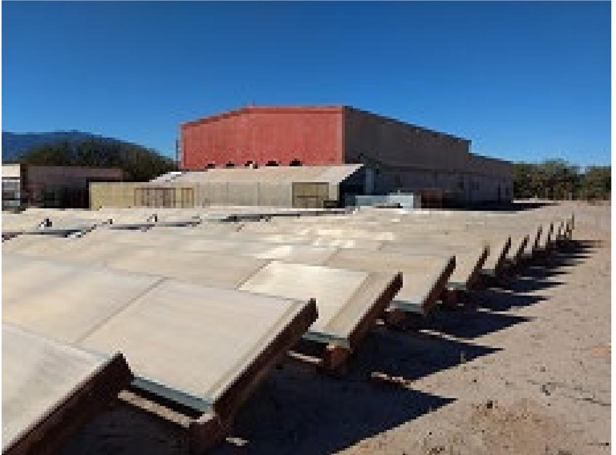
Foto 9: Secado por energía solar del pimentón en el predio de la cooperativa. Paneles solares al frente y túnel de secado al fondo y detalle del Túnel de Secado
