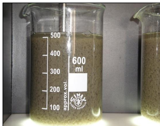
Figura 21: Prueba de efluente porcino con acondicionadores químicos.
