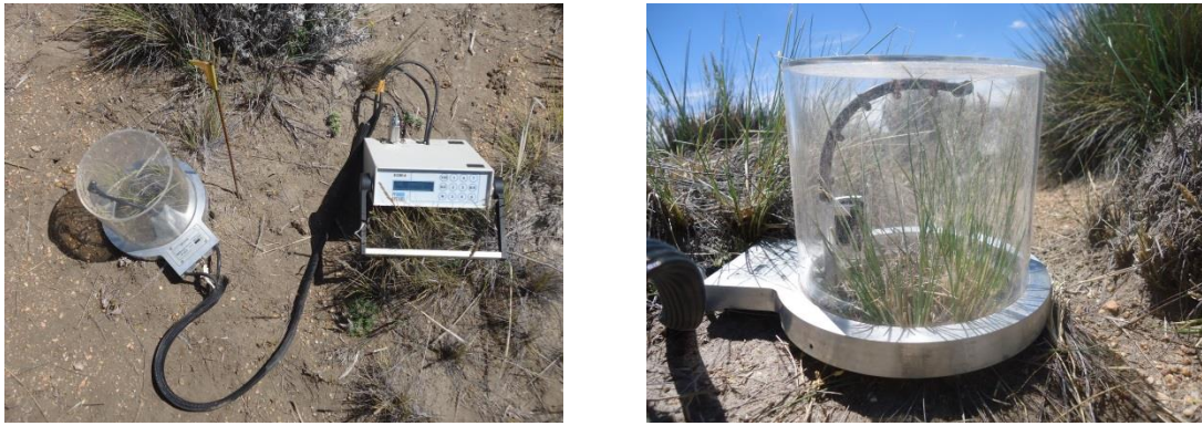
Figura 3.1. Instrumental utilizado para medir el intercambio neto de CO 2 del ecosistema: cámara transparente conectada al analizador de gases infrarrojos (Modelo EGM-4, PP Systems).
