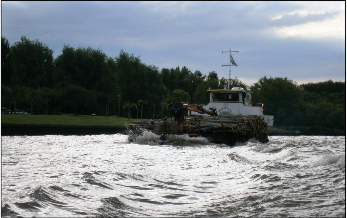
**Descripción:** álamos cosechados y transportados por una “chata” (barco) con una “pluma” (brazo hidráulico que sirve para alzar la madera desde el embarcadero).
