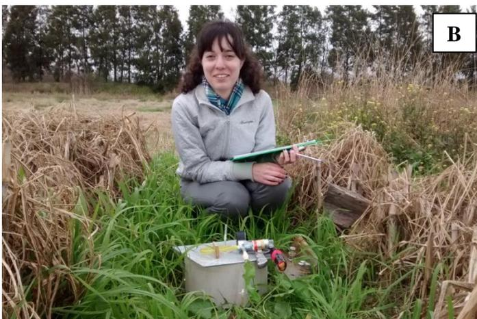
**Figura 3.3.** A. Cámara con todos sus componentes. B. Cámara ya instalada en el campo durante la medición. La base está inserta en el suelo y la tapa unida a ella por los cierres que la sujetan.
