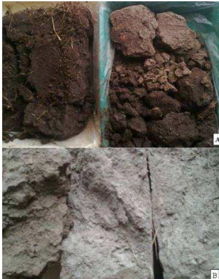
A- Comparación entre muestras de suelo: Calicata 1 (izquierda)-Calicata 2 (derecha); B-Comparación entre muestras de calicata 2 (izquierda) con un horizonte E de la Serie Los Hornos (centro, derecha).
