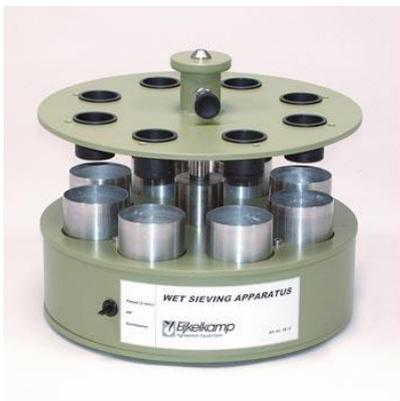
Figura 5.2. Imagen del equipo utilizado para medir estabilidad de agregados por el método de Kemper y Rosenau (1986).
