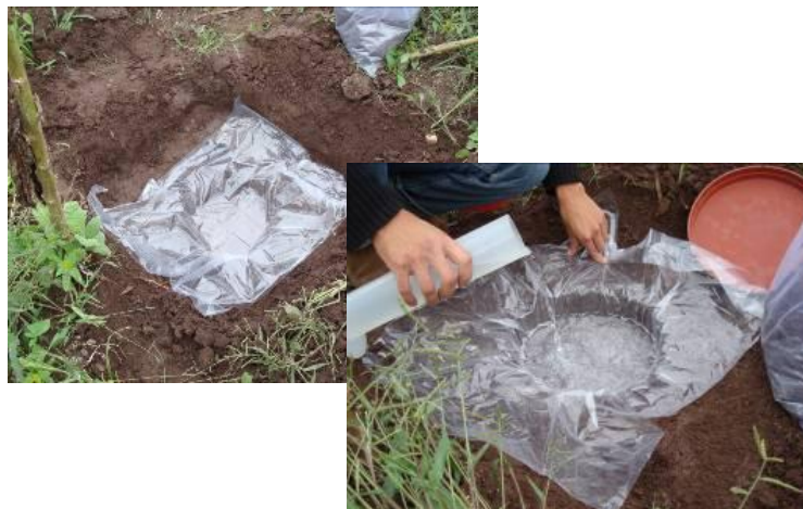
Foto 2. Enrase del pozo con volumen de agua conocido
