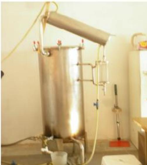
Foto N° 16 Equipo de destilación para la obtención de aceite esencial.
