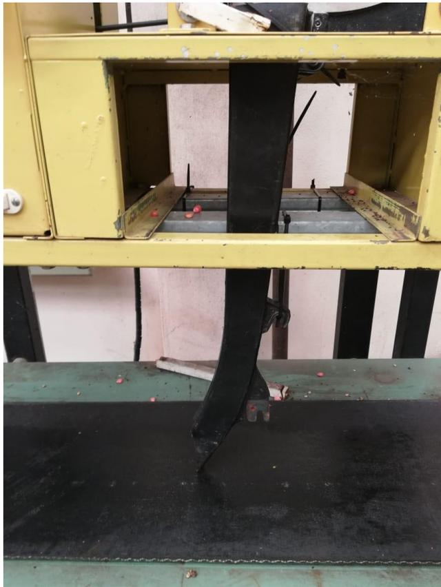
**Figura 3.** Tubo conductor curvo de marca: n/n de alistamiento usual en las sembradoras Schiarre.
