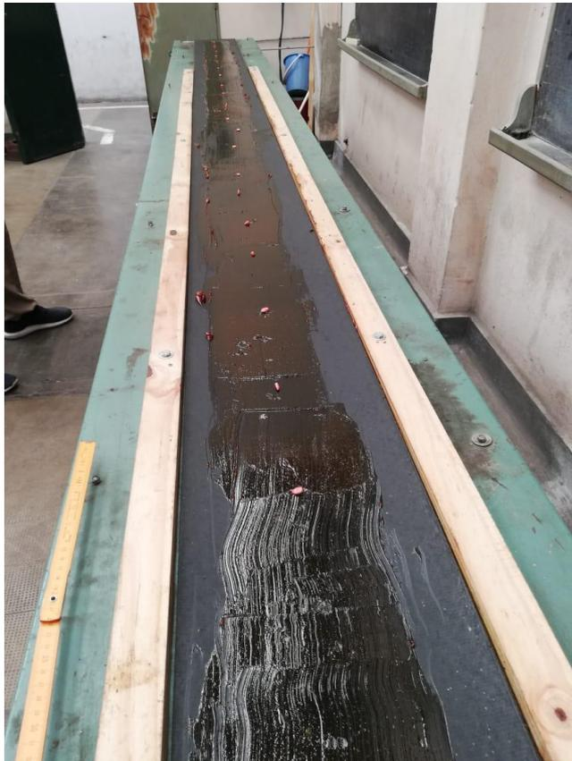
**Figura 4.** Cinta transportadora engrasada perteneciente al banco de ensayos.
