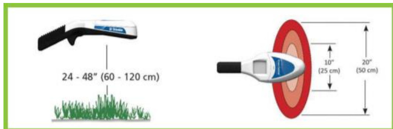
Figura 10. Forma de medición y fórmula para la determinación de NDVI . (Gutierrez et al., 2011)
