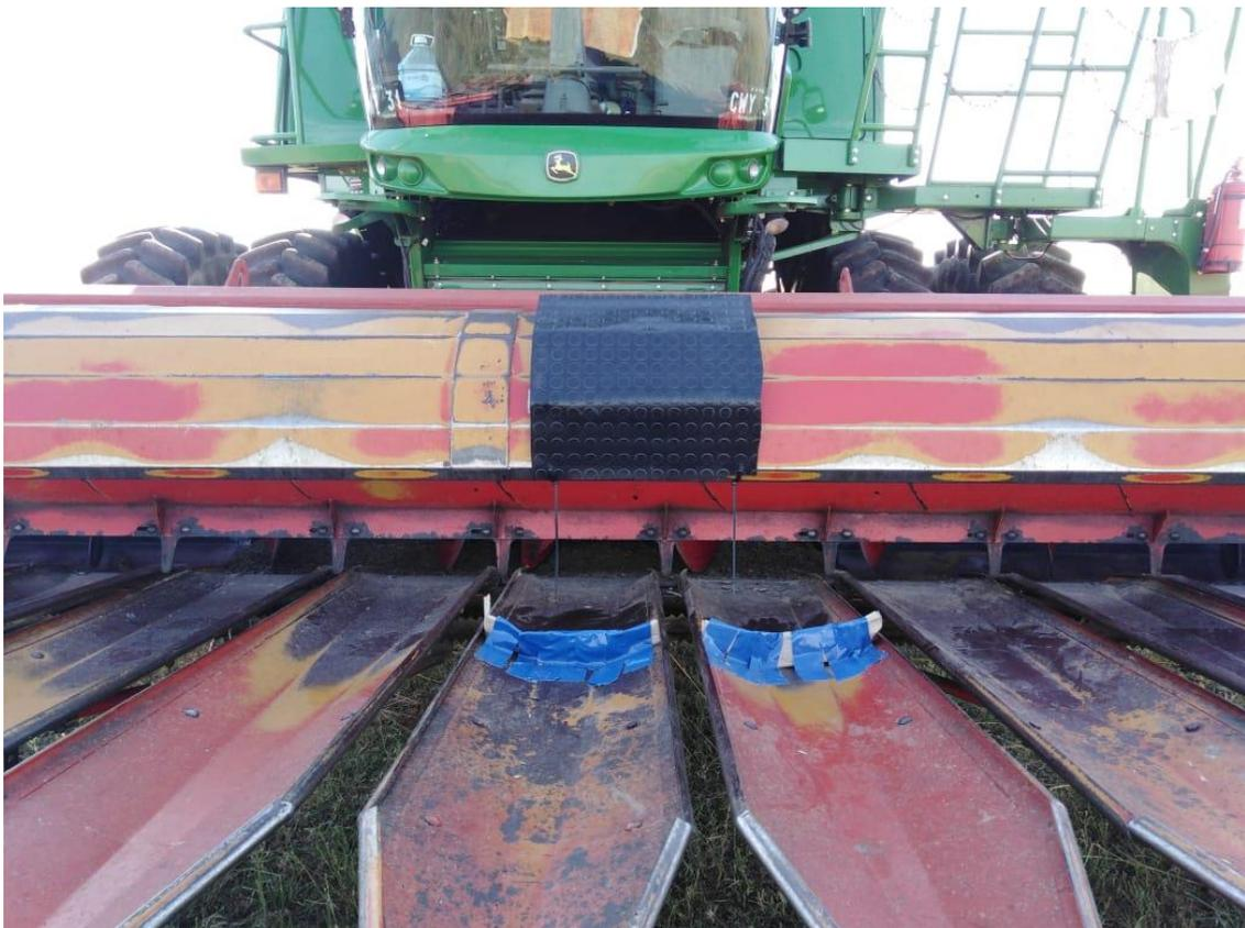
*Figura 16 - Escudo con recubrimiento de caucho sintético y topes.*
