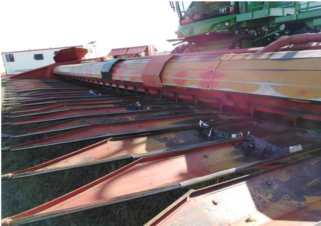
***Figura 17 - Escudos y topes montados sobre plataforma***
