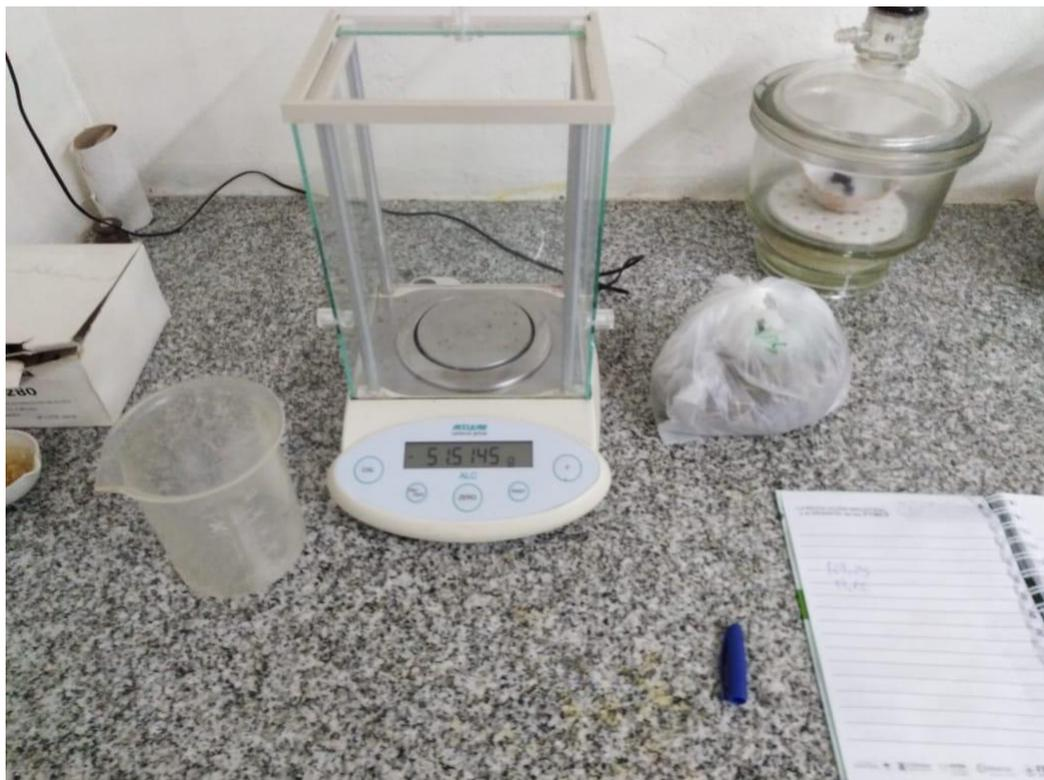
*Figura 18 - Pesaje de las muestras laboratorio de aguas UTN FRTL*
