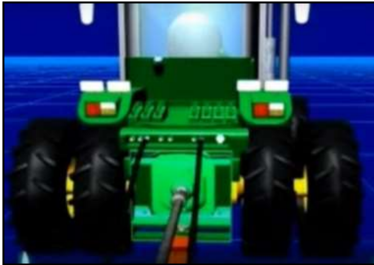
Toma de fuerza sin protección mecánica
