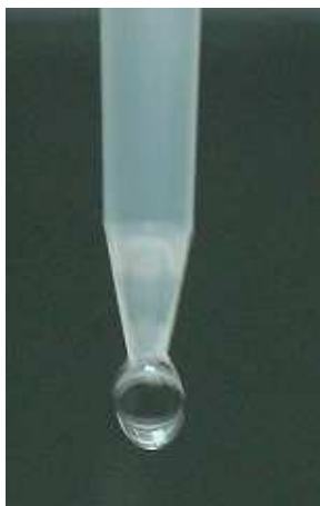
Foto N° 4: Formación de una gota utilizando la micropipeta volumétrica y para el To.
