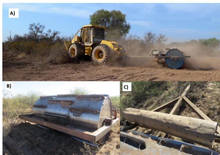
Figura 1.2 A) Tractor y rolo utilizado para el control de la vegetación leñosa; B) detalle del implemento (rolo); C) detalle del cajón de siembra.
