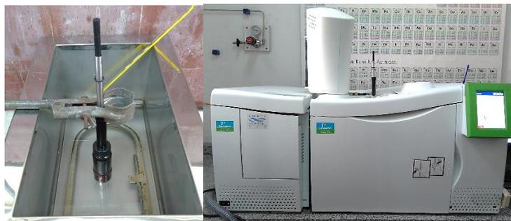
**Figura 2.4.** Izquierda: extracción de volátiles mediante SPME. Cromatógrafo gaseoso acoplado a espectrómetro de masas (GC-MS). GC Perkin Elmer Serie Clarus 580, MS Perkin Elmer Clarus SQ8S.
