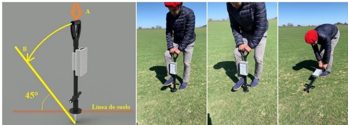
**Figura 1.3:** Modo de operación del Going Stick. El operador hinca el instrumento en el suelo, al penetrar el suelo mediante la fuerza ejercida en A, registra resistencia a la penetración; luego el operador inclina el mango  $45^\circ$  hacia el punto B, aquí registra tracción longitudinal.
