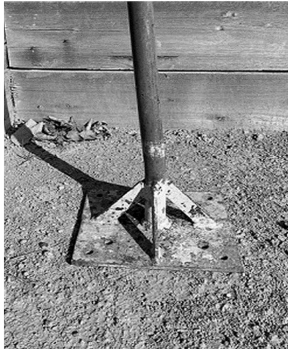
**Figura 2.4:** Imagen del pisón, masa de 4 kg lanzada tres veces desde una altura de 0,30 m sobre un área de 0,20 m por 0,17 m.
