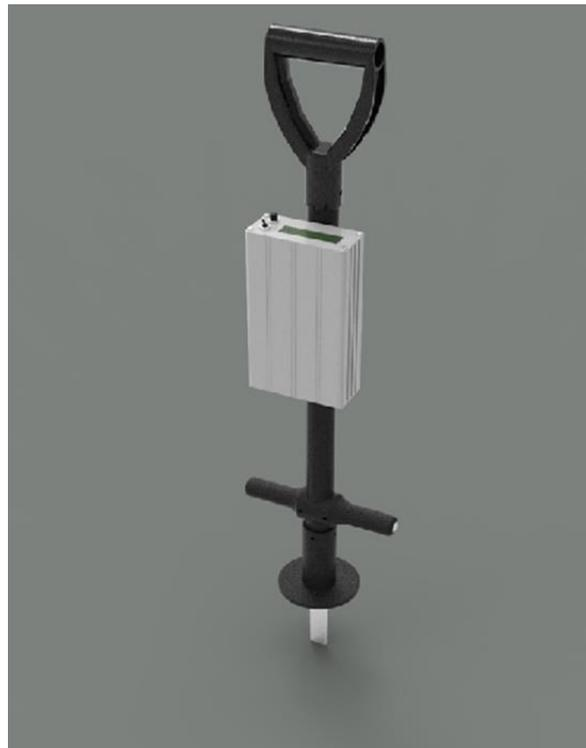
**Figura 2.5.** Sonda de sensor de fuerza de dos ejes (Going Stick).
