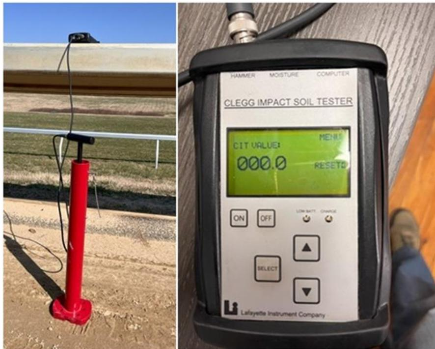
**Figura 4.2:** Dispositivo martillo Clegg a la izquierda y a la derecha detalle del display del datalogger.
