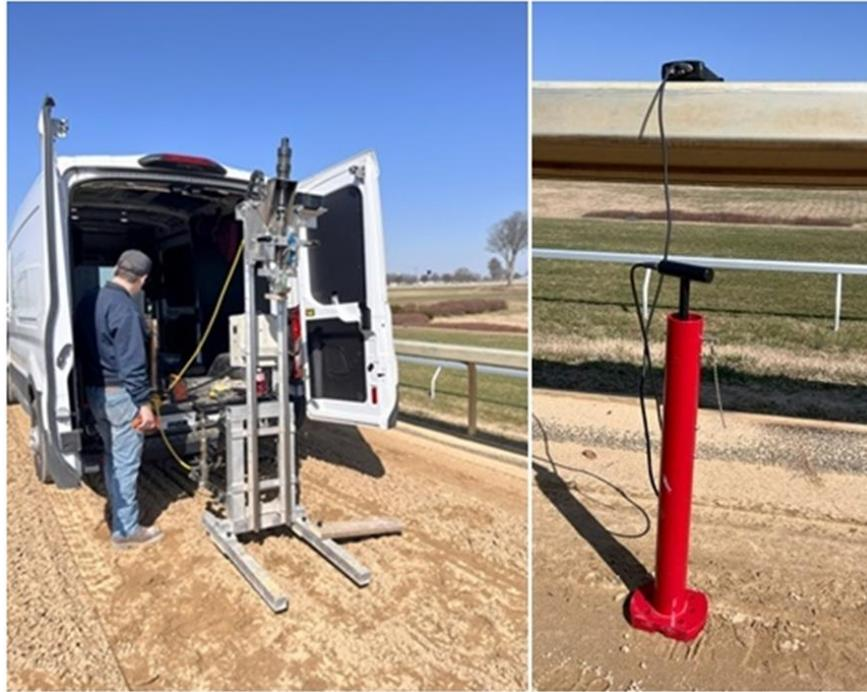
**Figura 1.5:** A la izquierda de la imagen el OBST montado sobre una camioneta y a la derecha el Clegg Hammer ambos sobre la misma superficie.
