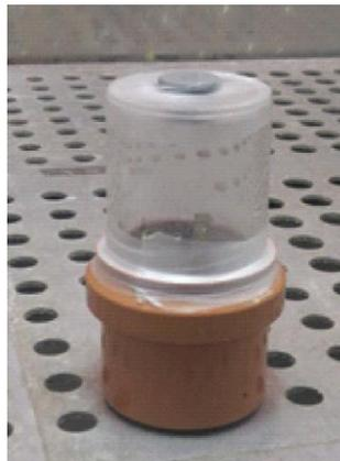
**Figura 3.4.** Detalle de una de las cámaras de incubación de suelo para el enriquecimiento de la atmósfera con acetileno.
