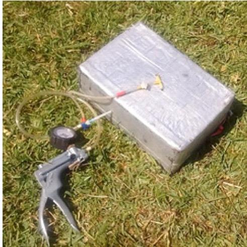
**Figura 3.2.** Detalle de la cámara de incubación conectada a la bomba de vacío para la toma de muestras de gases emitidos por el suelo.
