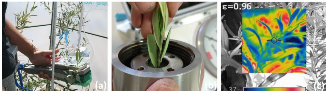
Figura 2.3. Medición de fotosíntesis en el interior de una OTC (a), medición de potencial agua (b), imagen térmica de hojas de olivo dentro de una OTC (c).
