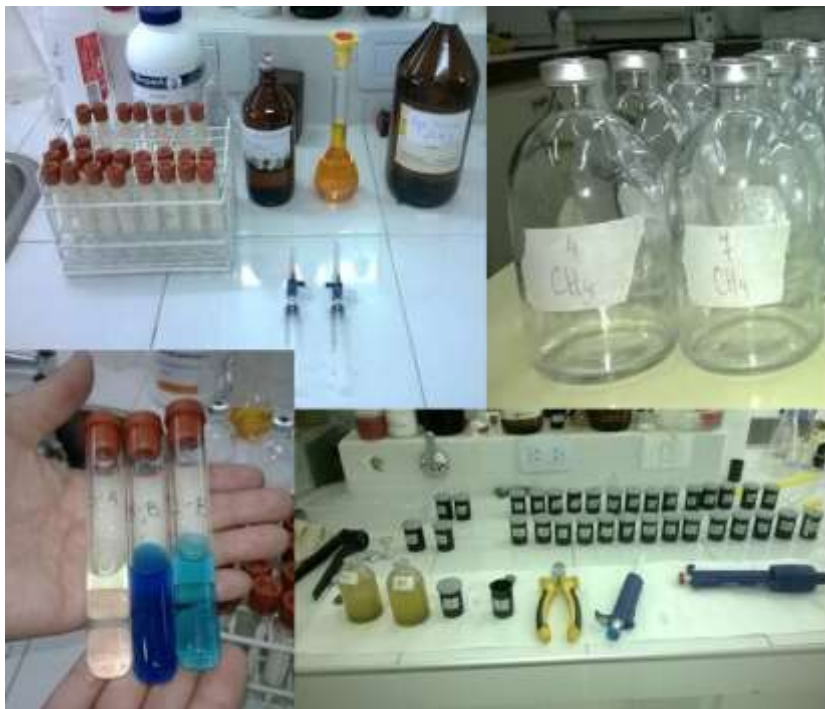
Figura 2.4. Determinación de sulfuro de hidrógeno, metano, amonio ruminal y ácidos grasos volátiles.
