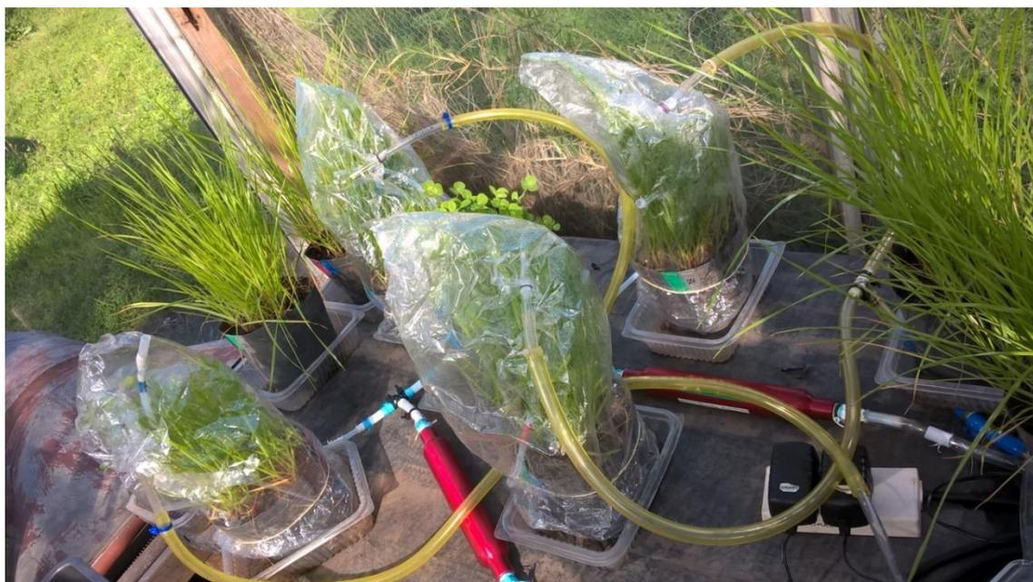
**Figura 3.1.** Fotografía del sistema de la colección de VOCs en el invernáculo.
