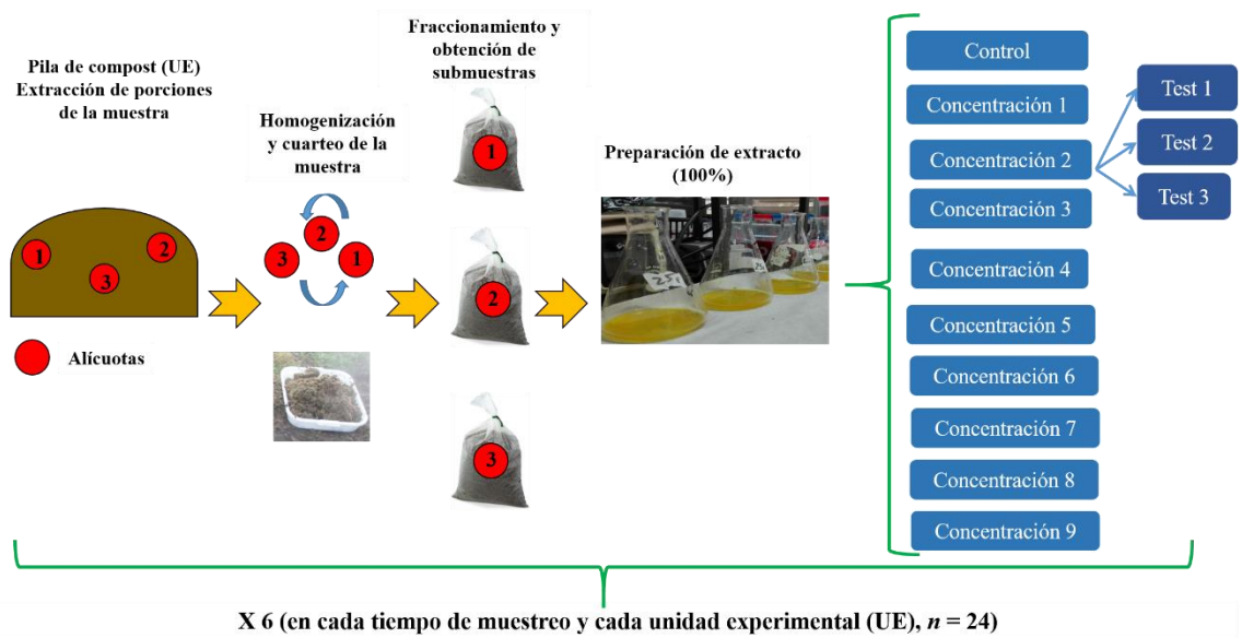
Figura 7.6. Esquema resumido del procedimiento para la obtención de muestras de compost (Experimento III) y preparación de extractos necesarios para los test de toxicidad ( L. sativa , R. sativus y D. magna ).
