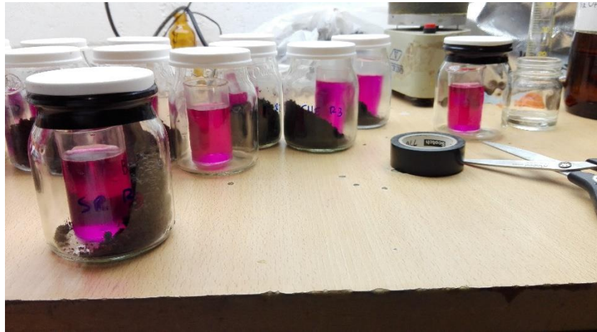
Imagen 3.4: Preparación de cámaras para medir respiración basal: 25 g de suelo fresco, trampa álcali NaOH 0,1 M con fenolftaleína.
