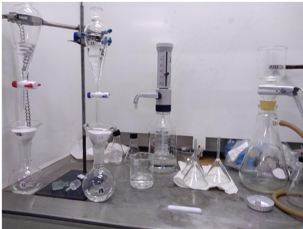
Imagen 3.7: Extracción líquido-líquido en campana de extracción. A las izquierda embudos de decantación con la muestra y una cantidad equivalente de diclorometano. Debajo los embudos con sulfato de sodio. A la derecha el matraz kitasato empleado en la filtración.
