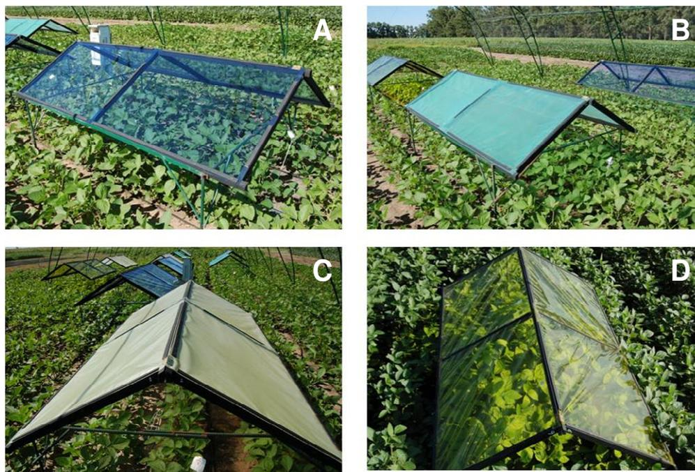
**Figura 5.3.** Imágenes de los tratamientos -R (filtro radiación rojo, A), -RL (filtro radiación rojo lejano, B), -N (filtro neutro, C) y -A (filtro radiación azul, D), para el experimento realizado durante la estación de crecimiento 2006/07 (Exp 7).
