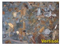
**Figura 4.3.** Fotografía de la fracción retenida sobre el tamiz de 53 μm para la determinación del carbono orgánico particulado (COP), mostrando la dispersión alcanzada con 3 h de agitado en ambos suelos evaluados.
