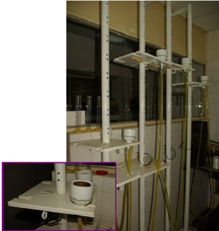
Figura 51. Ensayo de drenaje en mesas de succión
