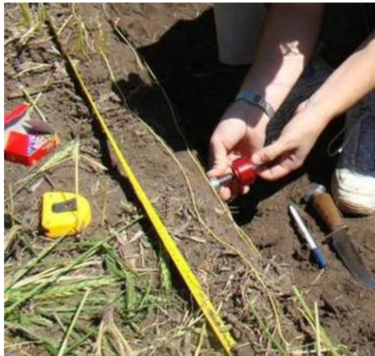
Figura 11. Medición in situ de resistencia de suelos al corte en el perfil del horizonte superficial del suelo.
