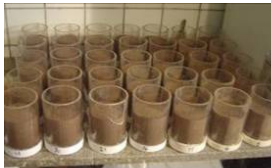
Figura 22. Columnas de suelo en cilindros de acrílico transparente para ensayo de h-s
