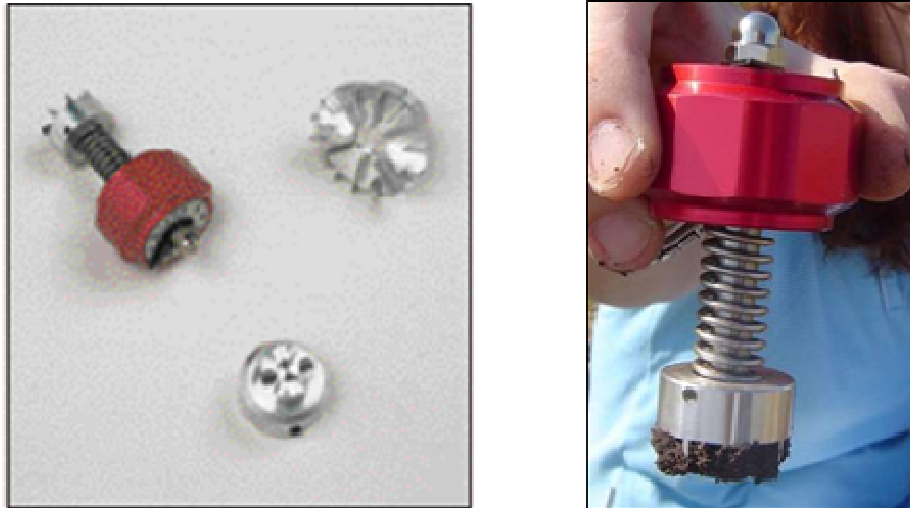
Figura 10. Equipo manual para medición de resistencia de suelos al corte.
