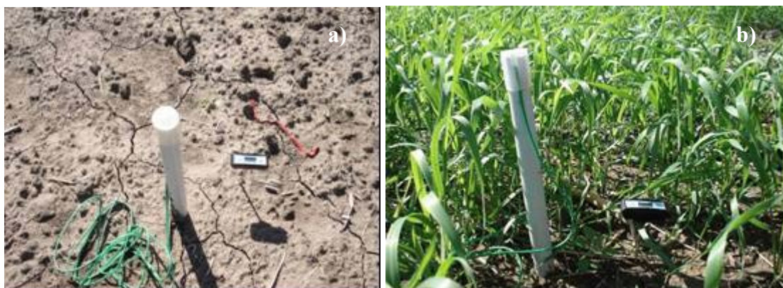
Figura 50: Sondas para medición de humedad volumétrica en el tratamiento Rotación M-T/S. a) clausura de 2,25 m 2 alrededor de la sonda y b) sonda en cultivo de trigo en macollaje
