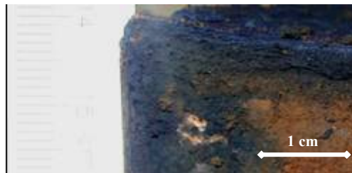
Figura 39. Fotografía del corte longitudinal de los primeros 2 centímetros de una columna no compactada de muestra de suelo del espesor 0,05-0,2 m luego de 15 ciclos de h-s
