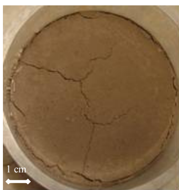
Figura 36. Fotografía de la vista de superficial de una columna no compactada de muestra de suelo del espesor 0,05-0,2 m luego de 15 ciclos de h-s.
