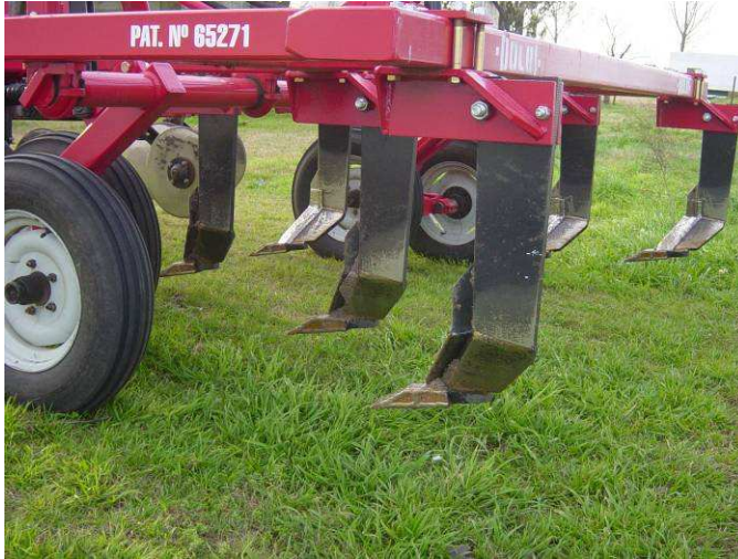
Foto 1.2. Paratill® utilizado para realizar descompactación profunda (30-40 cm).
