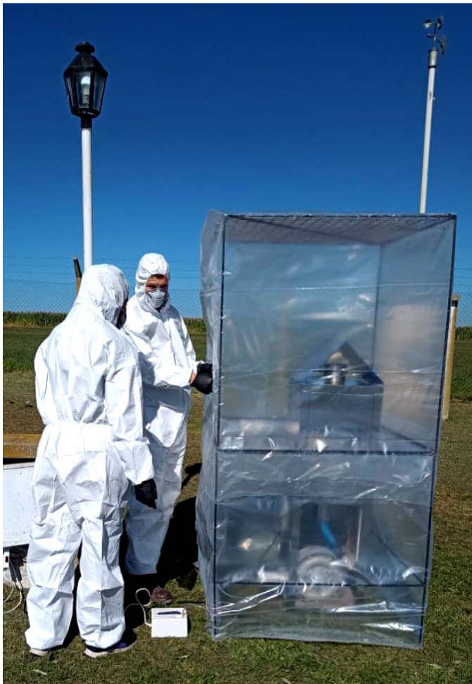
Figura 1. Fotografía real (a) y esquema (b) del equipo de aspiración de aire de alto volumen AR-PUF y cabina.
