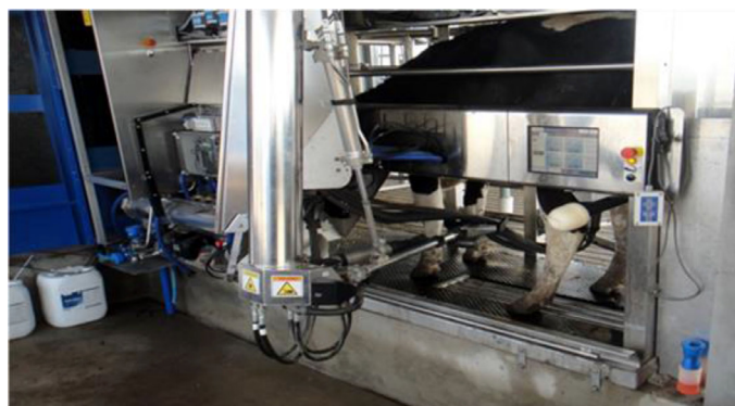
Figura 1. Vista posterior de un robot ordeñador. El modelo de brete simple posee un único brazo robótico el cual, a través de sensores, identifica a cada pezón de la ubre y realiza sobre los mismos todos los pasos de la rutina que habitualmente se hacen en un ordeño convencional.
